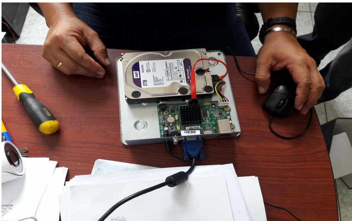
Ensamblaje del disco duro al NVR
