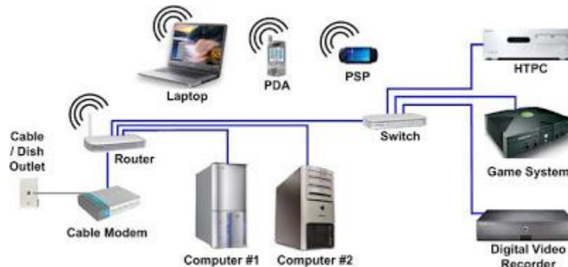
Figura 3. Componentes de una red. Fuente: http://redes-de-compu.blogspot.com
