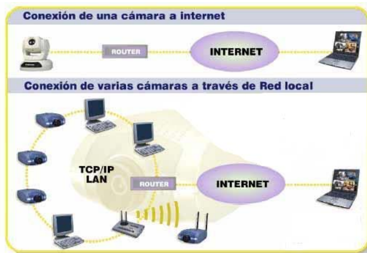
Figura 10. "Como se conecta una cámara IP a internet y a una LAN"
